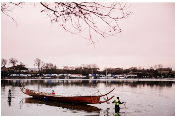
Et foto, der viser hvor lidt båden stikker i tom tilstand (10-12 cm).
